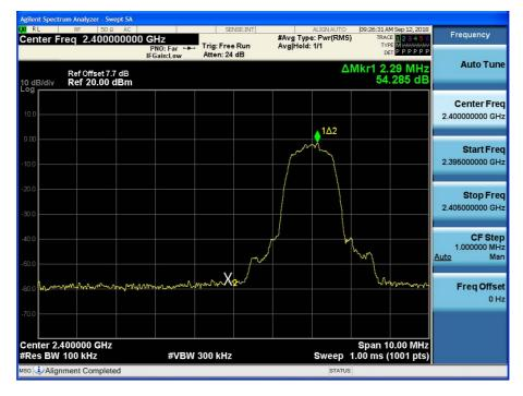
Test Plots without hopping ( $\pi$ /4DQPSK) Band Edges (CH.78)
