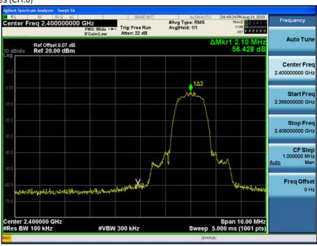
Test Plots without hopping ( $\pi/4DQPSK$ )
