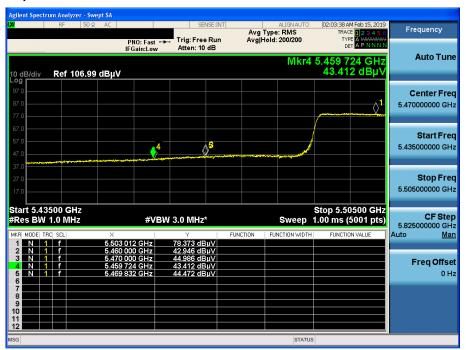
802.11ac(VHT80) & U-NII 2C & Ch.138 & X axis & Hor Detector Mode : AV
