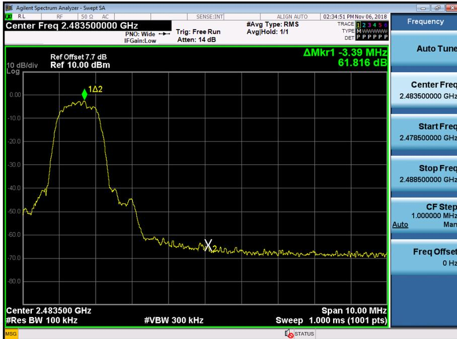
Test Plots without hopping ( $\pi/4$ DQPSK)
