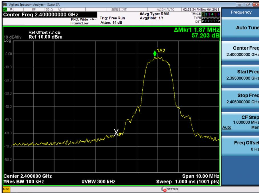
Test Plots without hopping ( $\pi/4$ DQPSK)
