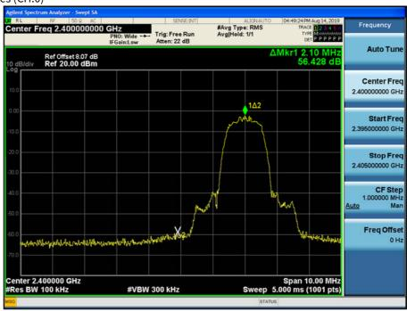
Test Plots without hopping ( $\pi/4DQPSK$ )
