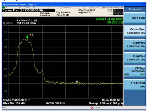
Test Plots without hopping ( $\pi/4DQPSK$ )
