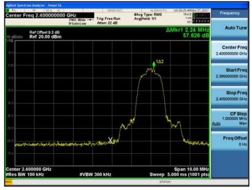
Test Plots without hopping ( $\pi$ /4DQPSK)
