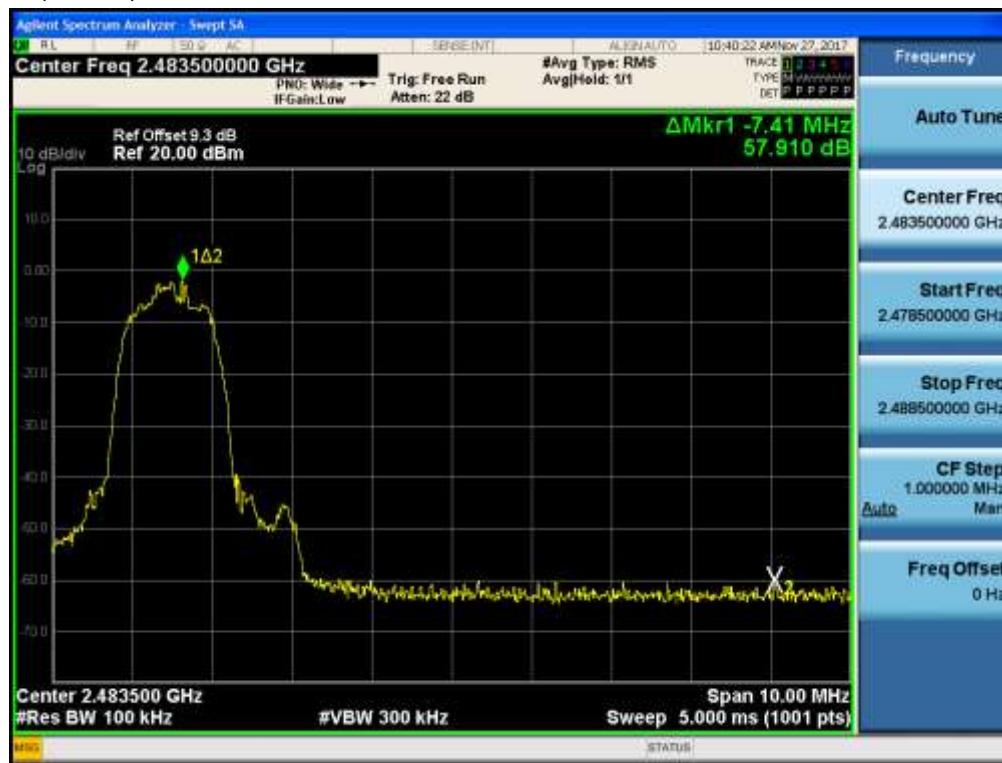
Test Plots without hopping ( $\pi/4$ DQPSK)
