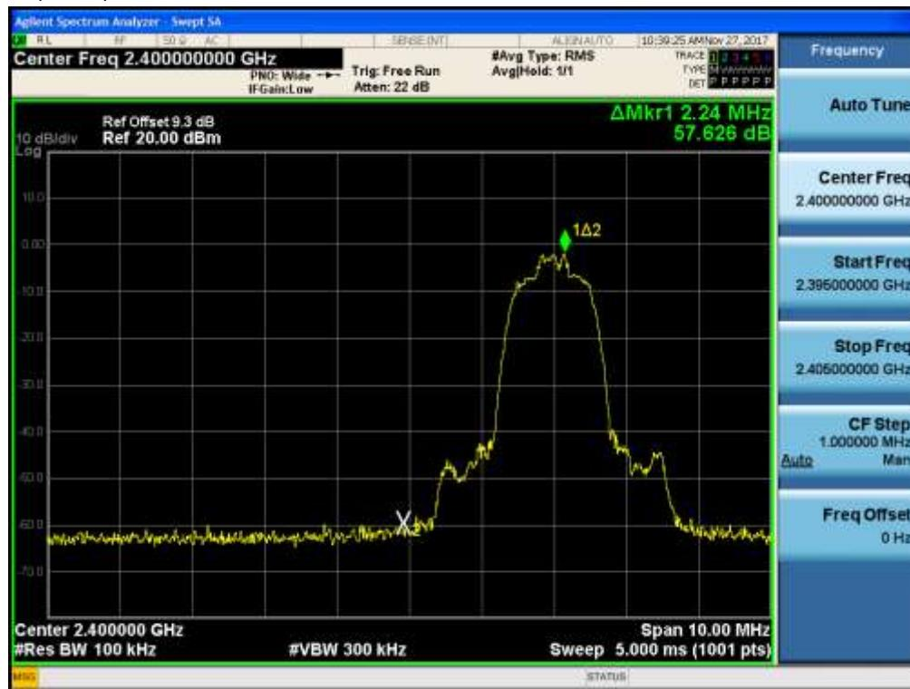
Test Plots without hopping ( $\pi/4$ DQPSK)
