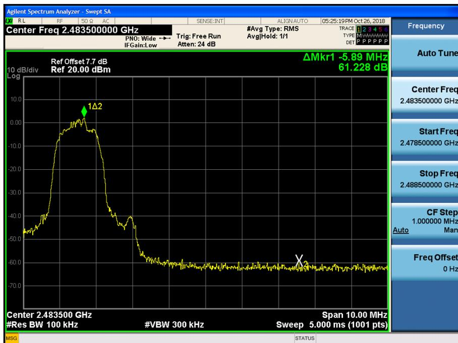
Test Plots without hopping ( $\pi/4$ DQPSK)
