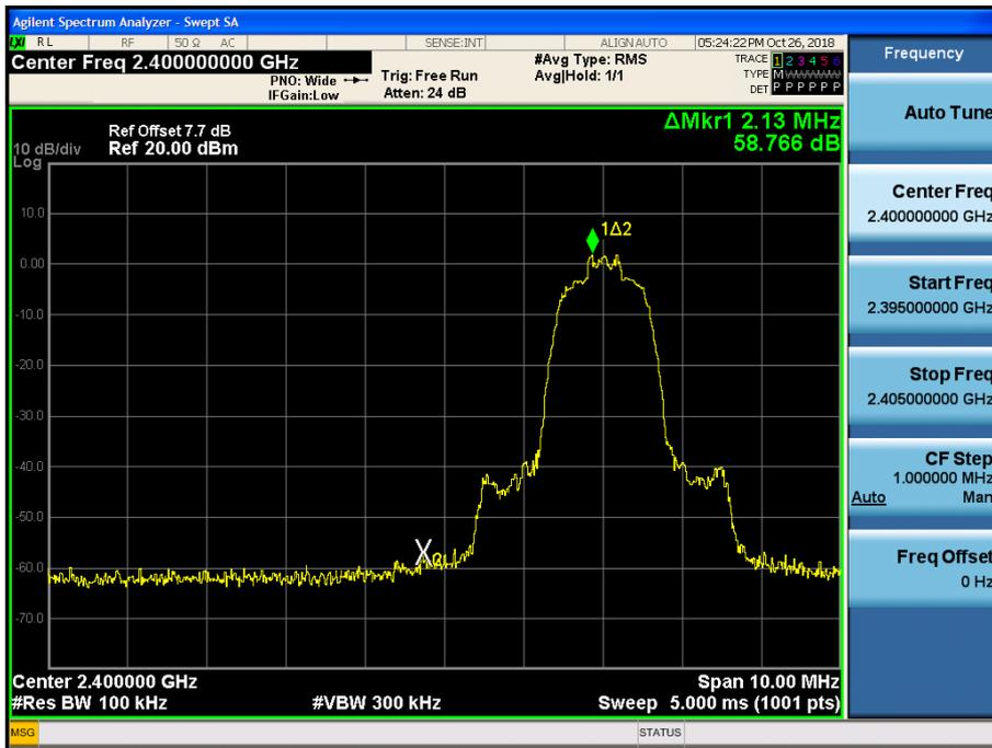
Test Plots without hopping ( $\pi/4$ DQPSK)
