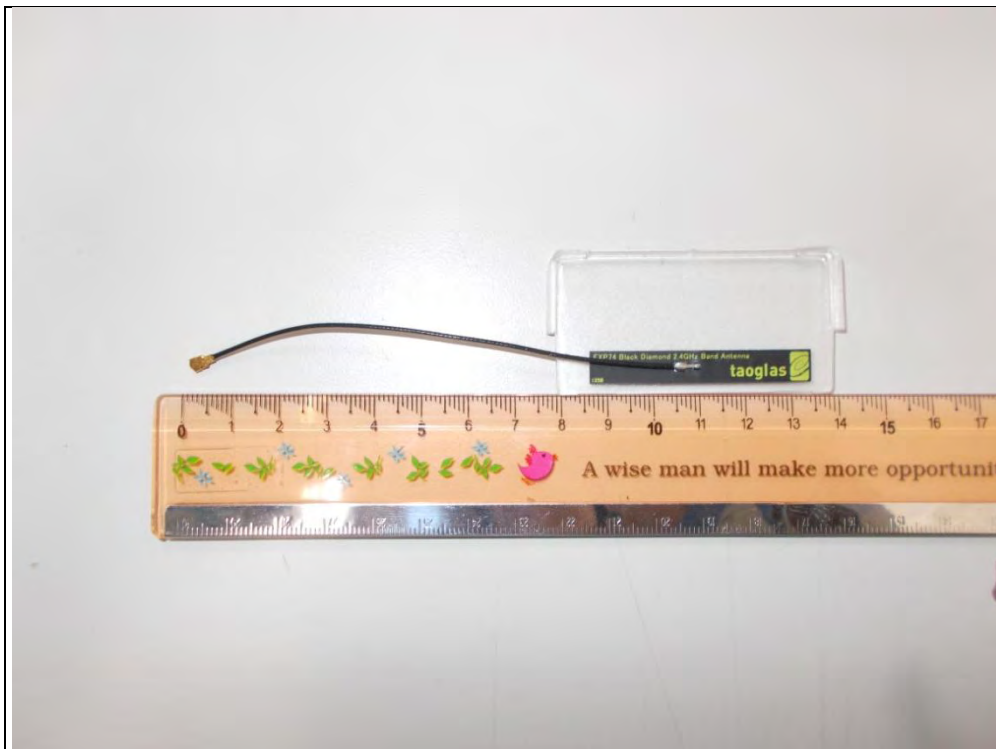
Antenna 4 (Brand: TAOGLAS ; Model: FXP74.07.0100A)
