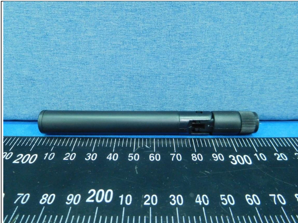
Dipole Antenna (Brand: LSR / Model: 001-0012)
