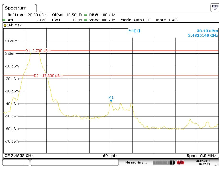
**EDR ( $\pi/4$ -DQPSK): Band Edge-Left Side**
