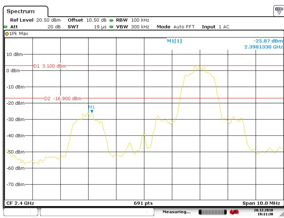
**EDR ( $\pi/4$ -DQPSK): Band Edge-Right Side**
