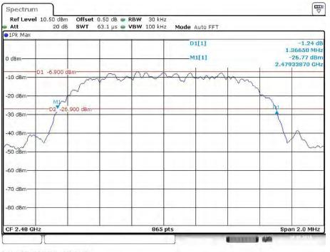
EDR ( $\pi$ /4-DQPSK): High Channel
