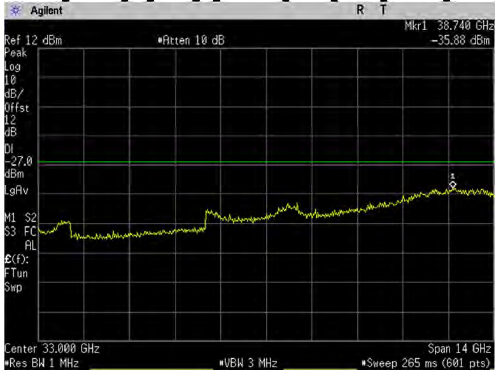
U-NII-2A_5270MHz_low_Mid Ch_54_40MHz BW_n-mode_-27dBm_26-40GHz_Port 2
