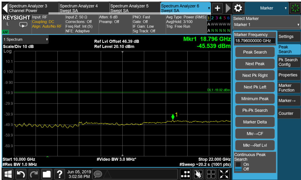
Configuration WCDMA+LTE-MIMO-MC-2 (2WCDMA 64QAM +1LTE QPSK)
