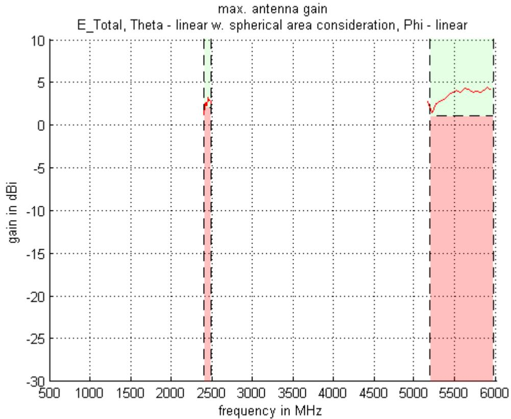
Max. Antenna Gain = Maximaler Gain in Hauptstrahlrichtung lt. KLH „ANTBTW-2305“
