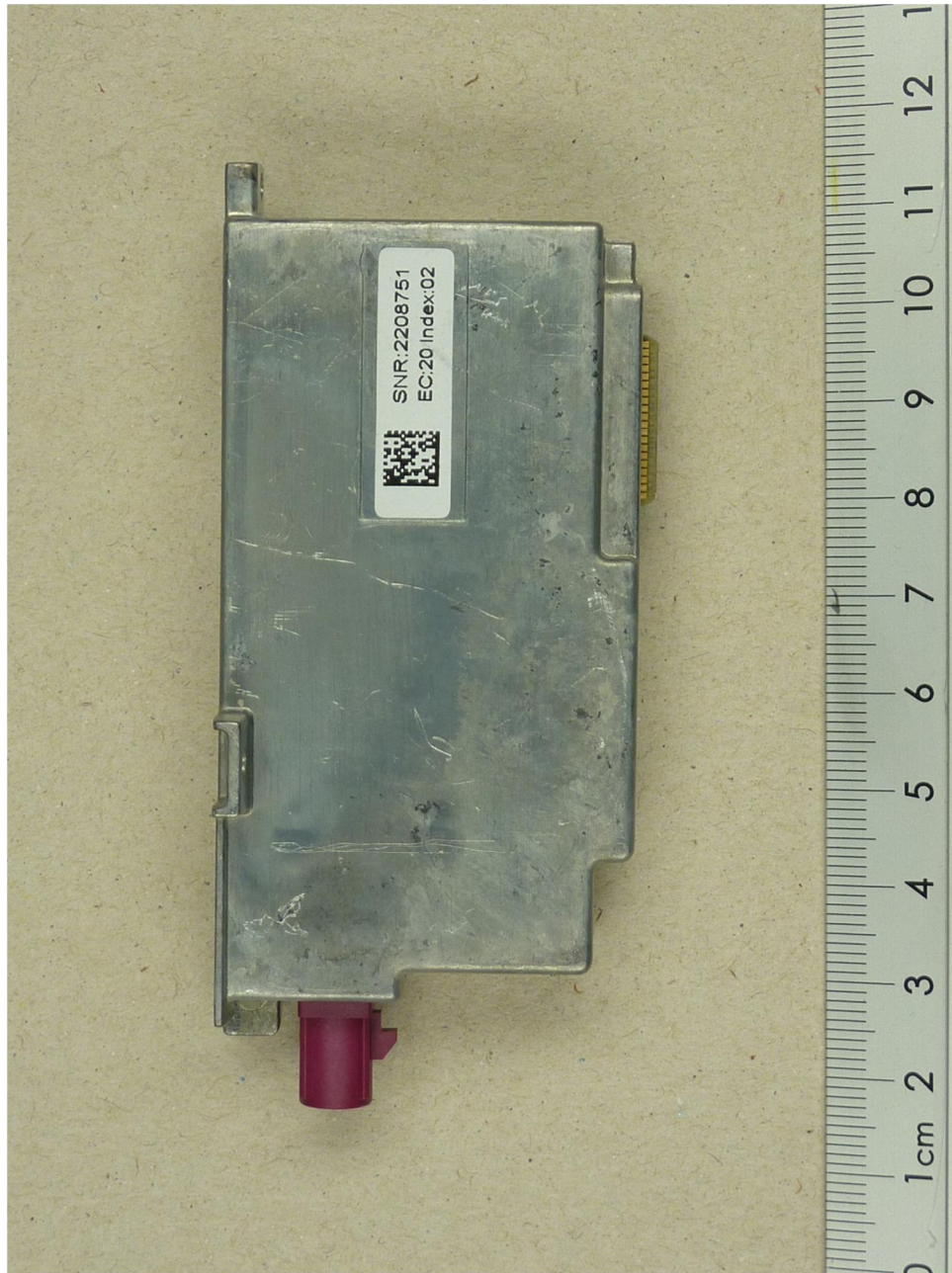
123736_26.JPG: UMTS module, bottom view
