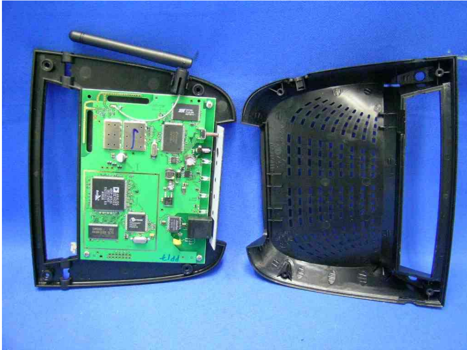
VoIP Gateway assembly
