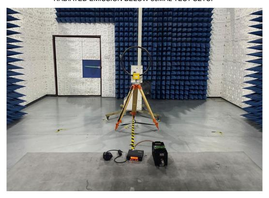
RADIATED EMISSION 30MHz-1GHz TEST SETUP
