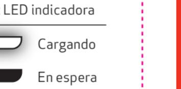
Si la luz LED roja está encendida pero el dispositivo no está recibiendo energía, es posible que haya algún objeto de metal cerca de las bobinas. Levante el dispositivo y retire cualquier objeto extraño cercano y vuelva a colocar el dispositivo de nuevo en la base de carga inalámbrica Verizon. Esta es una medida de seguridad y es parte de su funcionamiento normal.
