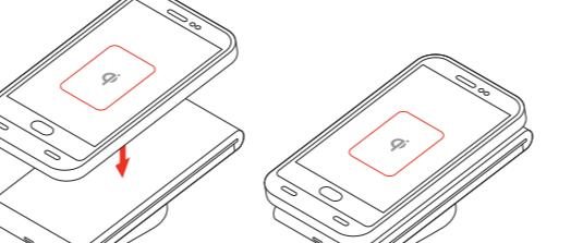
**4** Cuando se encuentra en el modo de espera, la luz LED está apagada. Una luz LED en rojo sólido indica que la base de carga inalámbrica Verizon está alimentando potencia máxima. Cuando el dispositivo habilitado con Qi esté completamente cargado, la base regresará al modo de espera y la luz LED se apagará.
