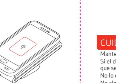
4 Cuando se encuentra en el modo de espera, la luz LED está apagada. Una luz LED en rojo sólido indica que la base de carga inalámbrica Verizon está alimentando potencia máxima. Cuando el dispositivo habilitado con Qi esté completamente cargado, la base regresará al modo de espera y la luz LED se apagará.
