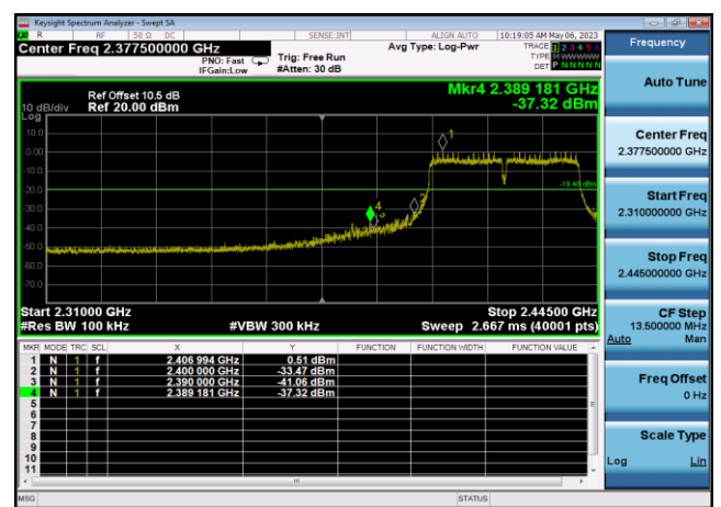
,Plot 2,Band Edge-802.11n(HT40) ,2452MHz,Ant0
