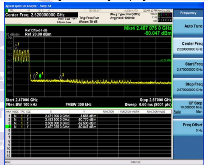
Right Band edge hopping on
