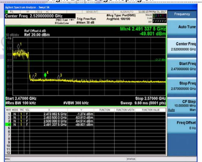
Right Band edge hopping on
