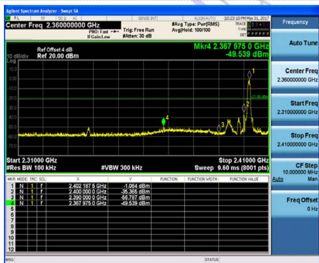
Left Band edge hopping off
