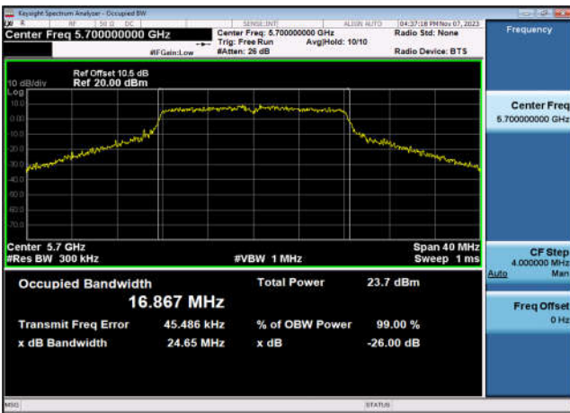
U-NII-2c 99% OBW & 26dB EBW-802.11ac(20MHz) ,5600MHz,Ant1
