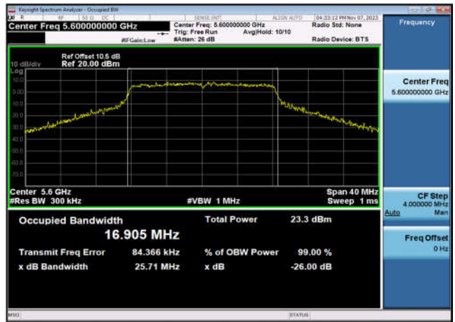
U-NII-2c 99% OBW & 26dB EBW-802.11ac(20MHz) ,5500MHz,Ant1
