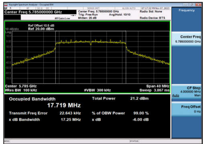
U-NII-3 6dB Bandwidth-802.11ac(40MHz) ,5755MHz,Ant1
