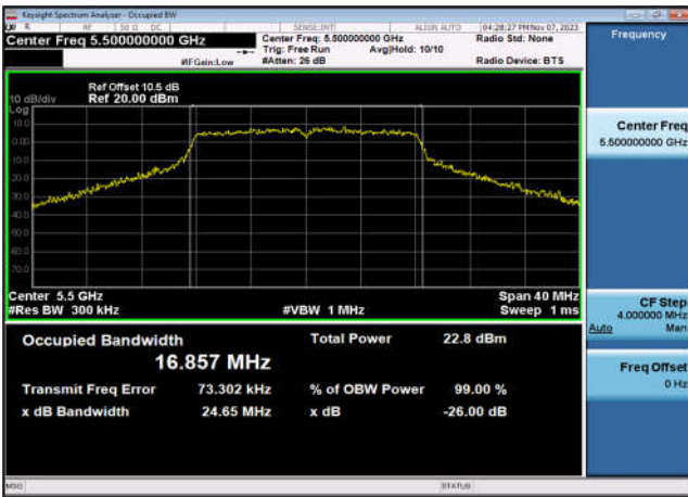
U-NII-2c 99% OBW & 26dB EBW-802.11a(20MHz) ,5700MHz,Ant1
