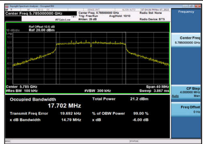
U-NII-3 6dB Bandwidth-802.11n(40MHz) ,5755MHz,Ant1
