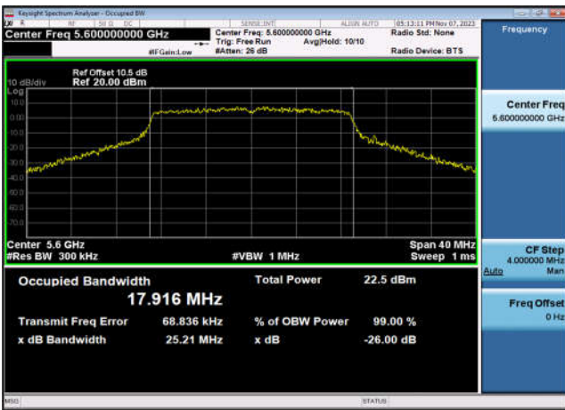
U-NII-2c 99% OBW & 26dB EBW-802.11ac(20MHz) ,5600MHz,Ant1
