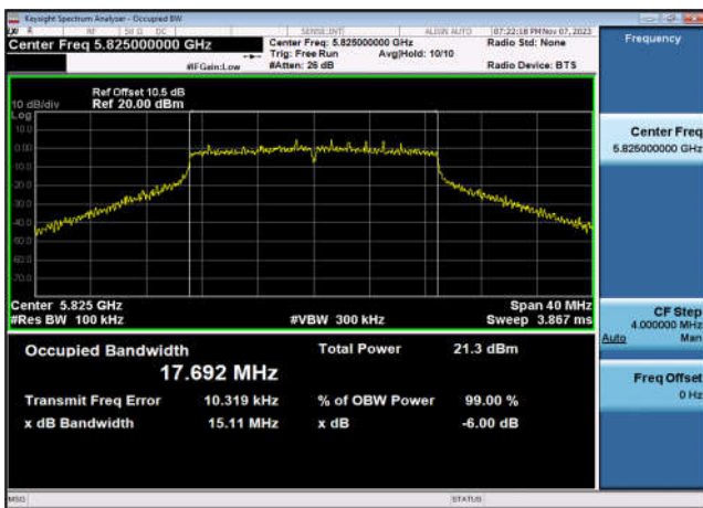
U-NII-3 6dB Bandwidth-802.11ac(20MHz) ,5825MHz,Ant1
