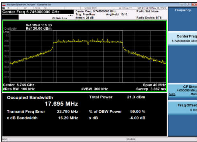
U-NII-3 6dB Bandwidth-802.11ac(20MHz) ,5825MHz,Ant1
