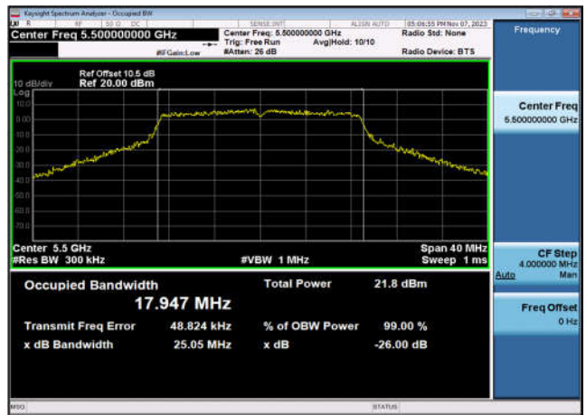
U-NII-2c 99% OBW & 26dB EBW-802.11ac(20MHz) ,5700MHz,Ant1
