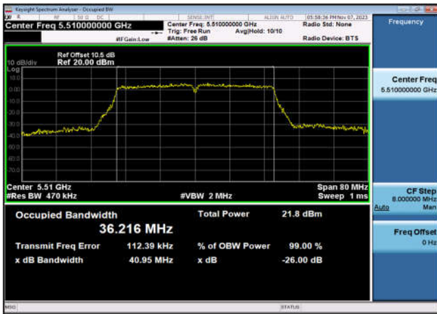
U-NII-2c 99% OBW & 26dB EBW-802.11ac(40MHz),5670MHz,Ant1
