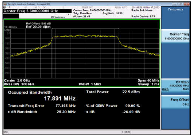
U-NII-2c 99% OBW & 26dB EBW-802.11n(40MHz) ,5510MHz,Ant1
