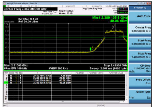
,Plot 2,Band Edge-802.11n(HT20) ,2462MHz,Ant0
