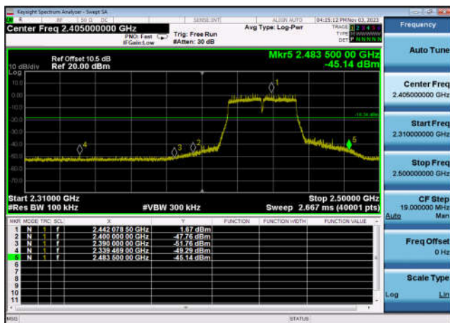
,Plot 2,Band Edge-802.11n(HT40) ,2437MHz,Ant0
