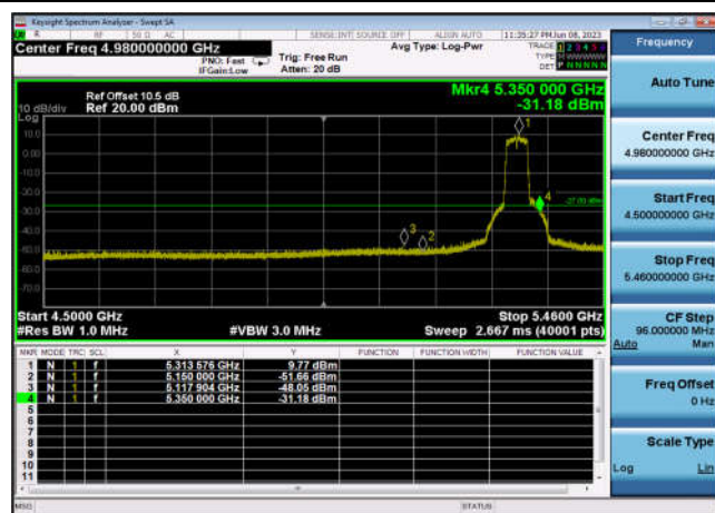
U-NII-2a ,Plot 1,Band Edge-802.11ac(4 0MHz),5310MHz,Ant1
