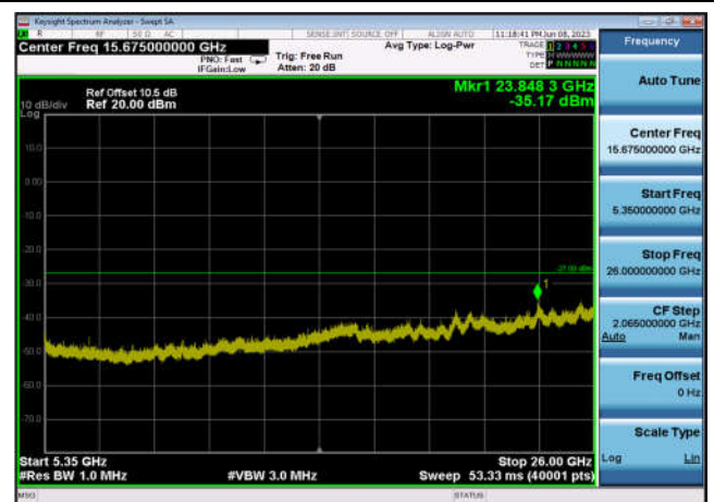
U-NII-2a ,Plot 3,5350MHz~26000MHz-802 .11ac(80MHz),5290MHz,Ant1
