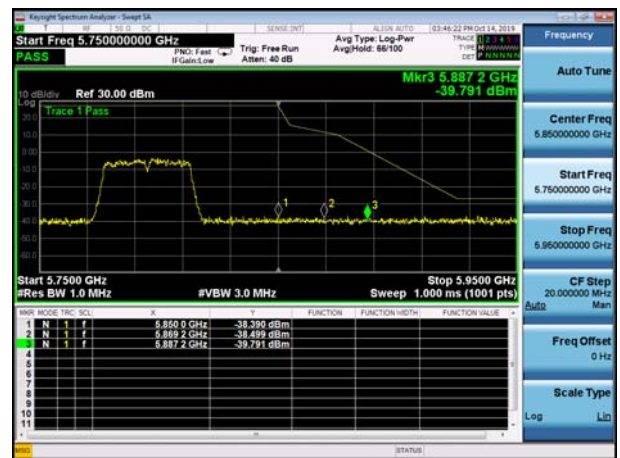
U-NII-3 ,Plot 1,Band Edge-802.11ac(40 MHz),5795MHz,Ant2
