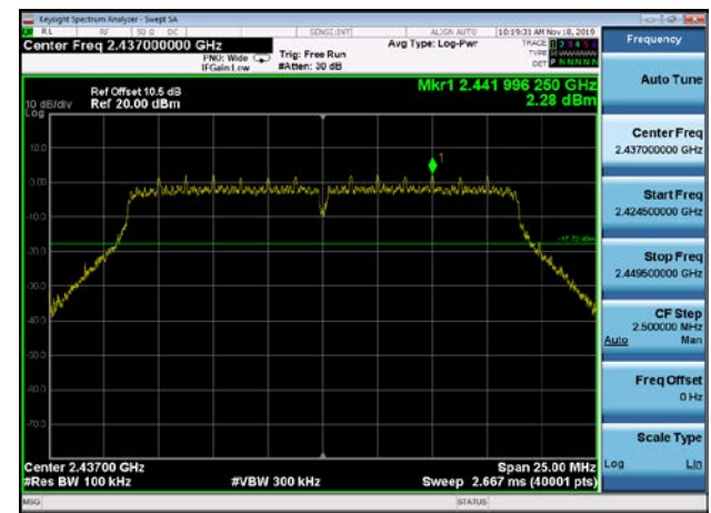
,Plot 2,Band Edge-802.11n(HT20) ,2412MHz,Ant0
