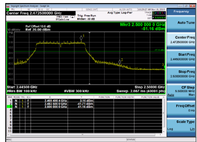
,Plot 2,Band Edge-802.11n(HT20) ,2462MHz,Ant0
