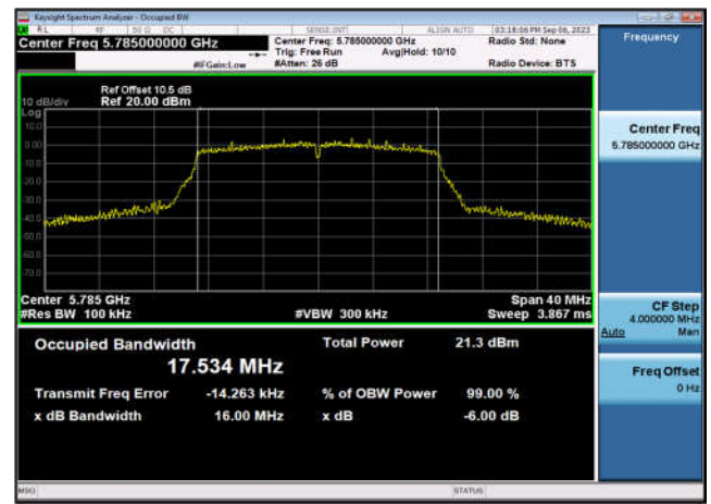
U-NII-3 6dB Bandwidth-802.11n(40MHz) ,5755MHz,Ant1
