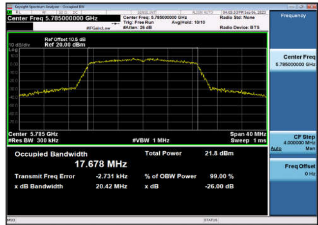
U-NII-3 26dB&99% Bandwidth-802.11ac(40MHz) ,5755MHz,Ant1
