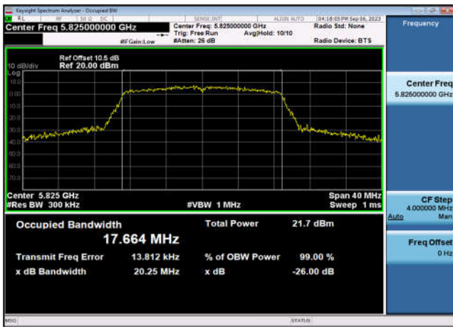
U-NII-3 26dB&99% Bandwidth-802.11ac(40MHz) ,5795MHz,Ant1
