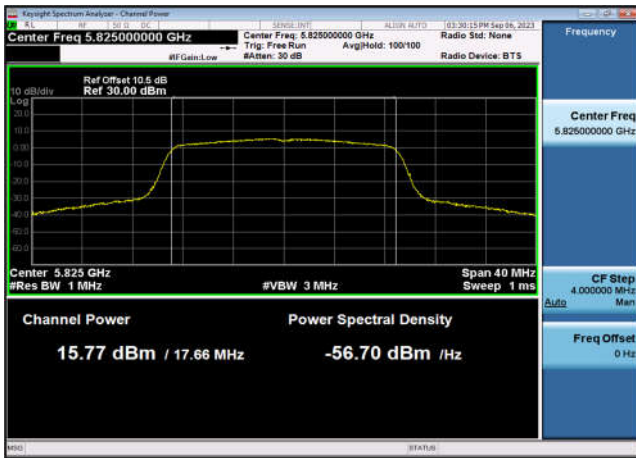
U-NII-3 Output Power-802.11n(40MHz) ,5795MHz,Ant1
