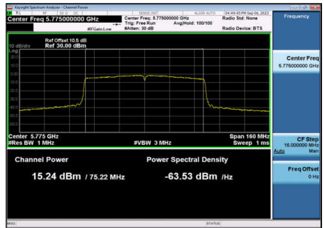
U-NII-3 Output Power-802.11n(20MHz) ,5785MHz,Ant1
