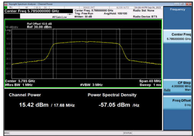
U-NII-3 Output Power-802.11ac(40MHz) ,5755MHz,Ant1
