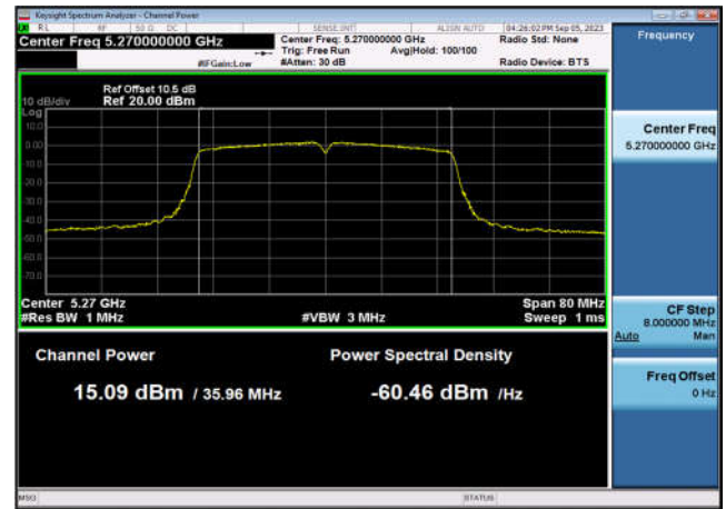
U-NII-2a Output Power-802.11ac(80MHz) ,5290MHz,Ant1
