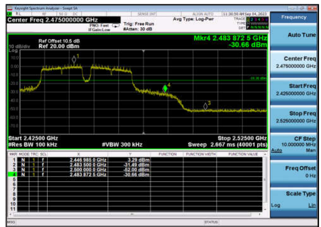
,Plot 2,Band Edge-802.11n(HT40) ,2452MHz,Ant0
