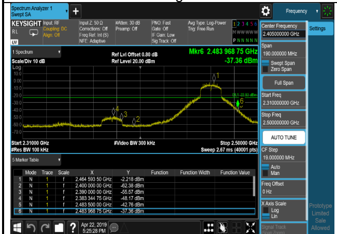
802.11g,2462MHz,Ant0,Plot 4,2500MHz~5 000MHz
