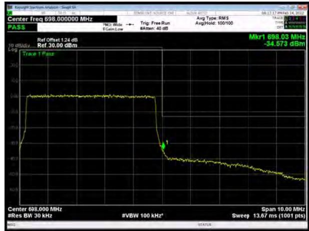
LTE Band 71 16QAM 10MHz CH-Low, 1 RB
