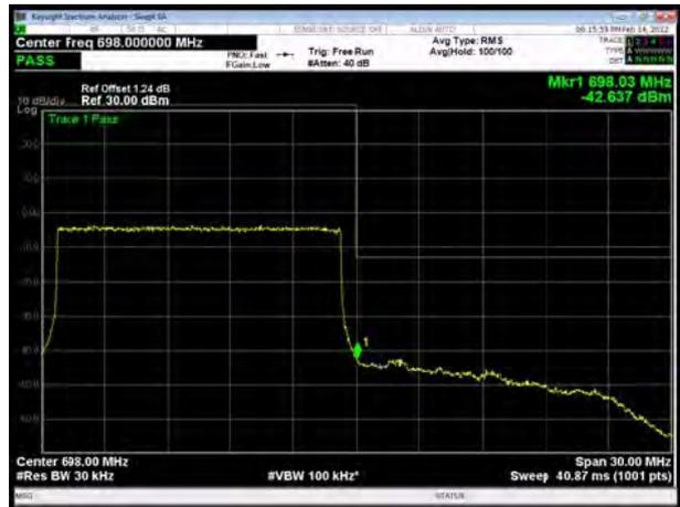
LTE Band 71 16QAM 20MHz CH-Low, 1 RB
