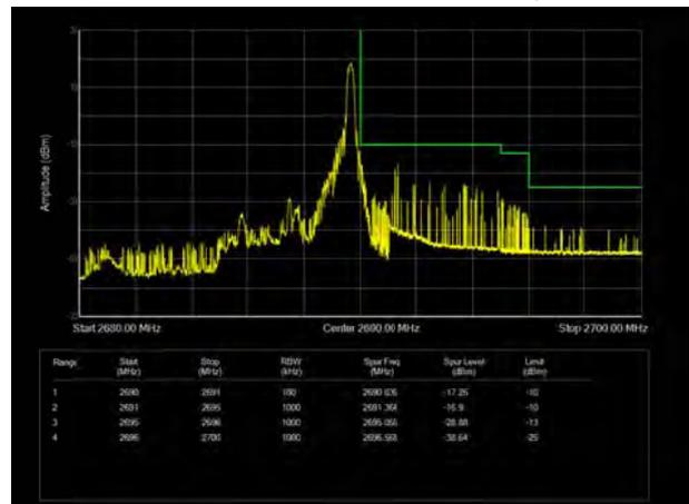
LTE Band 41 64QAM 5MHz CH-Low, 100%RB
