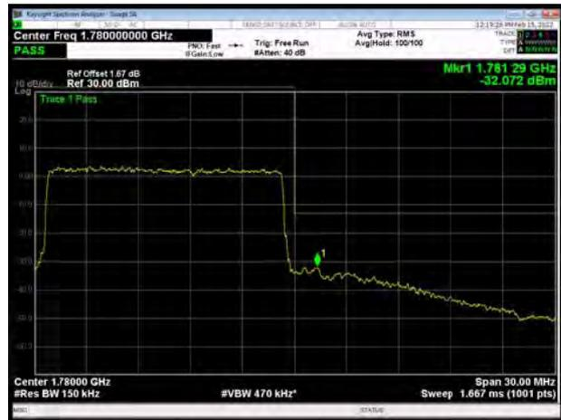
LTE Band 66 16QAM 20MHz CH-Low, 1 RB
