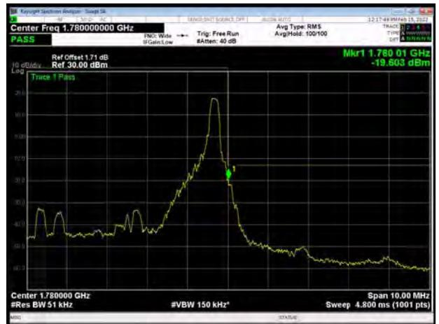
LTE Band 66 16QAM 5MHz CH-Low, 100%RB
