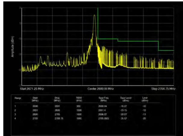
LTE Band 41 64QAM 15MHz CH-Low, 100%RB
