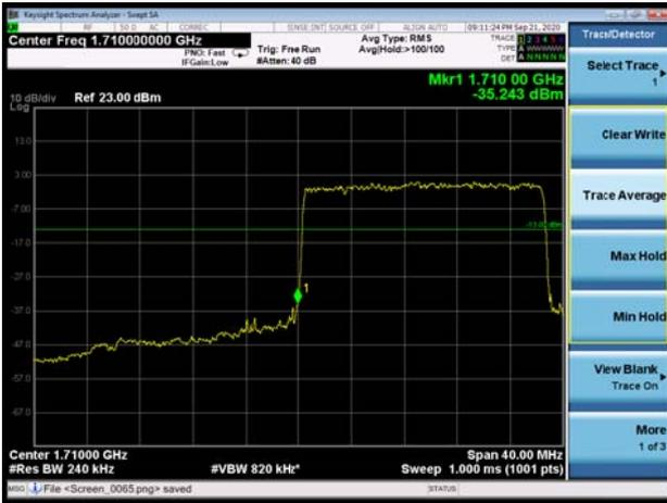
EN-DC\_2A\_n66 20MHz 16QAM 100%RB
