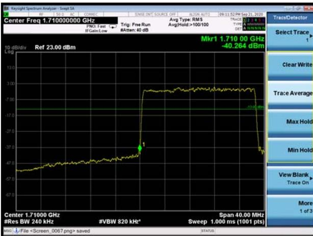
EN-DC\_2A\_n66 20MHz 64QAM 100%RB
