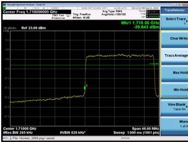
EN-DC\_2A\_n66 20MHz 256QAM 100%RB
