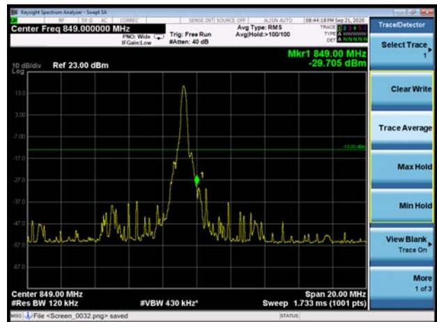
EN-DC\_2A\_n5 16QAM 10MHz CH-Low 100%RB
