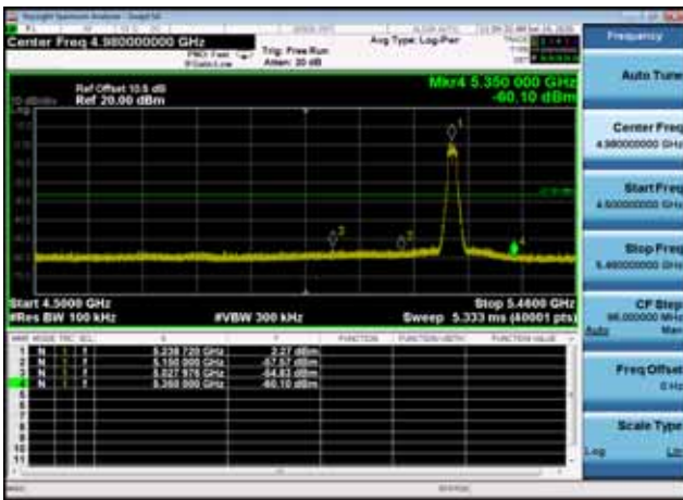
U-NII-1 ,Plot 1,Band Edge-802.11ac(20 MHz),5180MHz,Ant0
