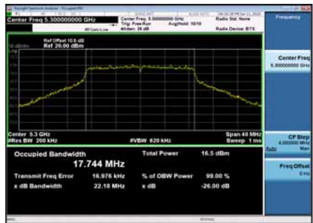
U-NII-2a 26dB Bandwidth-802.11n(20MHz),5320MHz,Ant1
