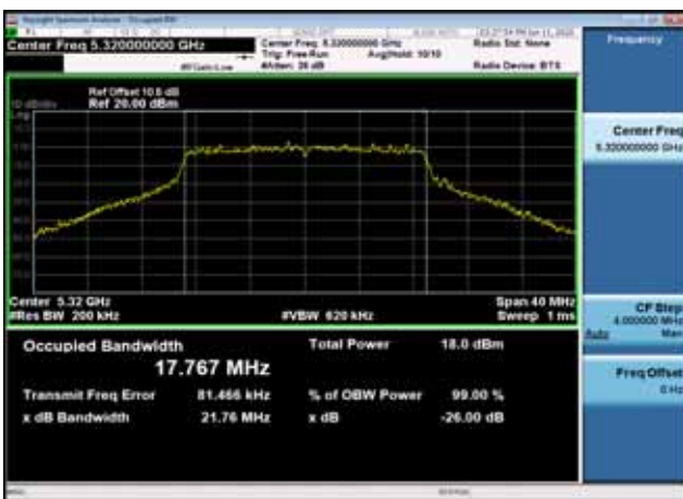
U-NII-2a 26dB Bandwidth-802.11n(40MHz),5270MHz,Ant0
