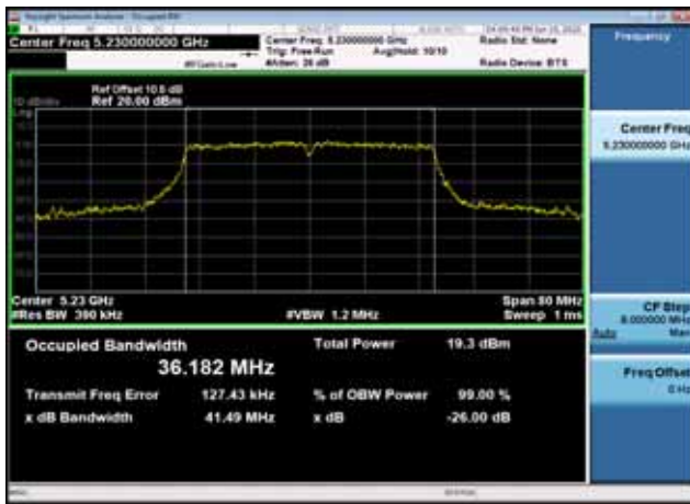
U-NII-1 26dB Bandwidth-802.11ac(80MHz),5210MHz,Ant0
