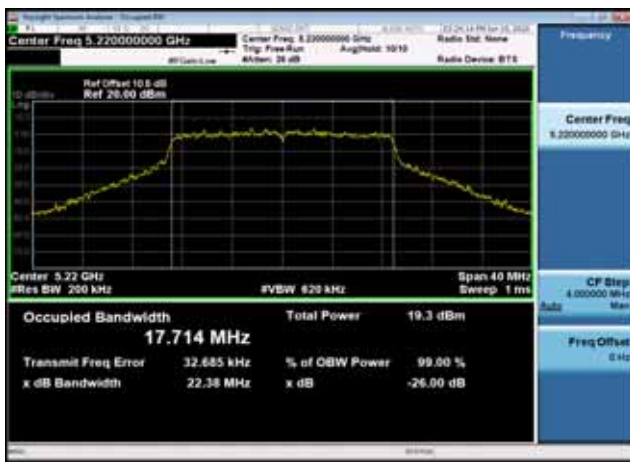
U-NII-1 26dB Bandwidth-802.11ac(20MHz),5240MHz,Ant0
