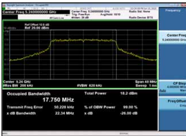
U-NII-1 26dB Bandwidth-802.11ac(40MHz),5190MHz,Ant0
