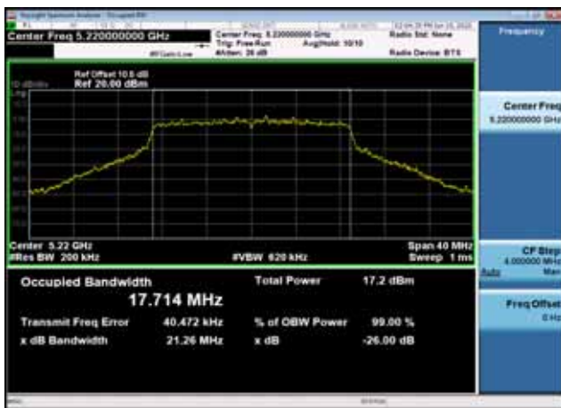
U-NII-1 26dB Bandwidth-802.11n(20MHz) ,5240MHz,Ant0
