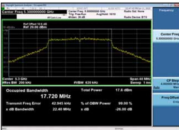
U-NII-2a 26dB Bandwidth-802.11ac(20MHz),5300MHz,Ant0
