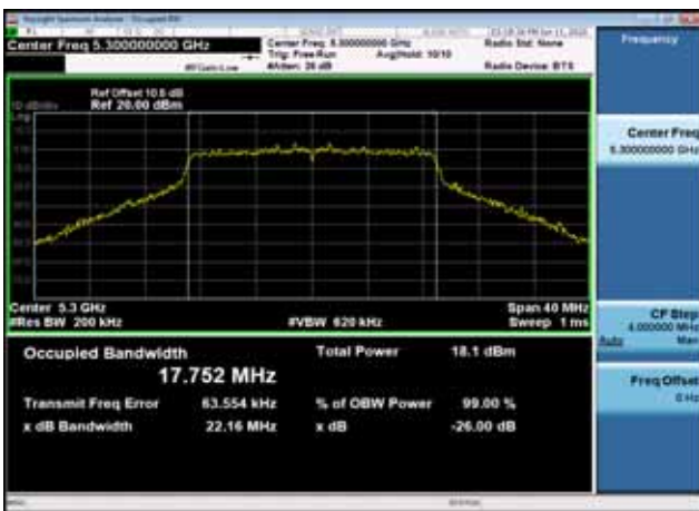
U-NII-2a 26dB Bandwidth-802.11n(20MHz),5320MHz,Ant0
