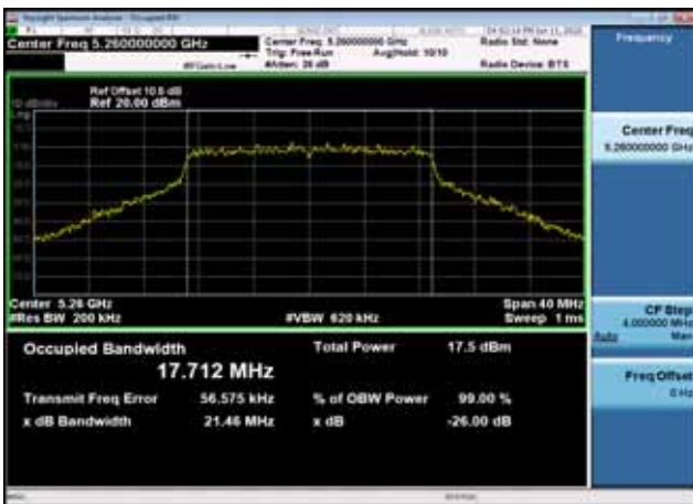
U-NII-2a 26dB Bandwidth-802.11ac(20MHz),5300MHz,Ant0
