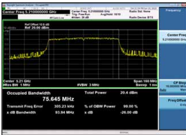
U-NII-2a 26dB Bandwidth-802.11n(20MHz),5260MHz,Ant0
