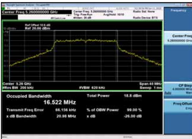
U-NII-2a 26dB Bandwidth-802.11a(20MHz),5300MHz,Ant0
