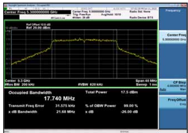
U-NII-2a 26dB Bandwidth-802.11ac(20MHz),5300MHz,Ant1
