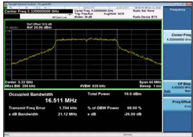
U-NII-2a 26dB Bandwidth-802.11ac(20MHz),5260MHz,Ant1
