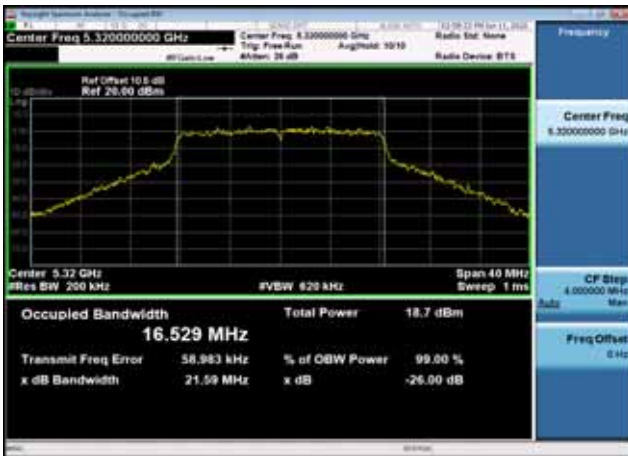
U-NII-2a 26dB Bandwidth-802.11ac(20MHz),5260MHz,Ant0
