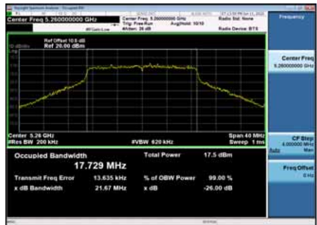
U-NII-2a 26dB Bandwidth-802.11ac(20MHz),5300MHz,Ant1
