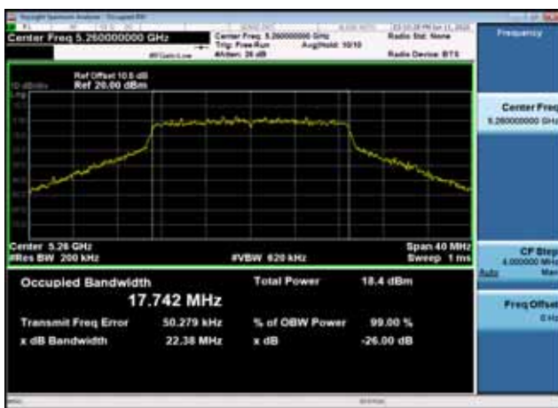
U-NII-2a 26dB Bandwidth-802.11n(20MHz),5260MHz,Ant0
