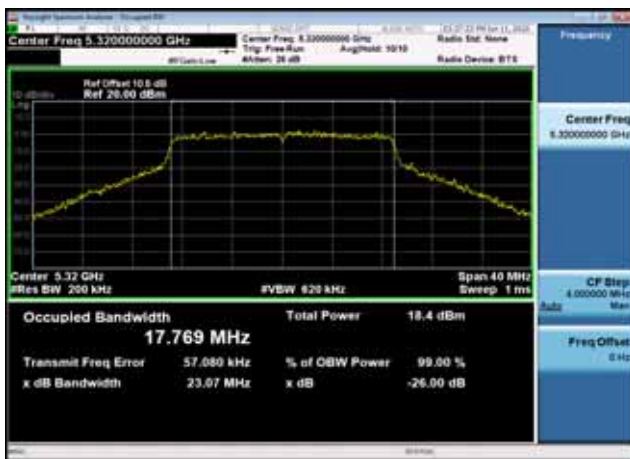
U-NII-2a 26dB Bandwidth-802.11ac(40MHz),5270MHz,Ant0
