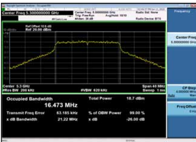
U-NII-2a 26dB Bandwidth-802.11a(20MHz),5300MHz,Ant0
