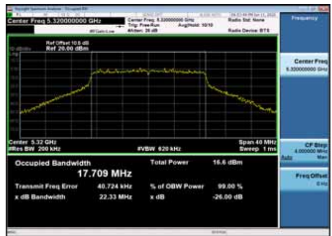
U-NII-2a 26dB Bandwidth-802.11ac(40MHz),5270MHz,Ant1
