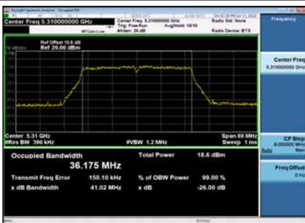
U-NII-2a 26dB Bandwidth-802.11ac(40MHz),5310MHz,Ant0
