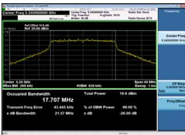
U-NII-1 26dB Bandwidth-802.11n(20MHz) ,5240MHz,Ant0
