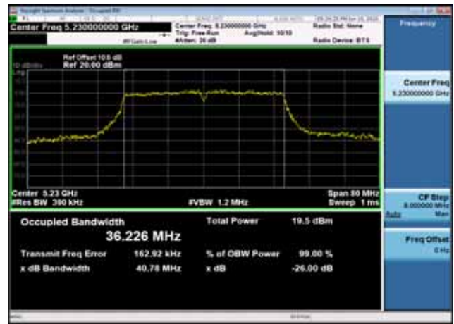
U-NII-1 26dB Bandwidth-802.11ac(80MHz),5210MHz,Ant1
