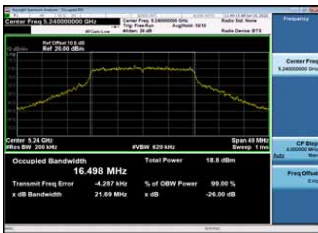
U-NII-1 26dB Bandwidth-802.11ac(20MHz) ,5180MHz,Ant0
