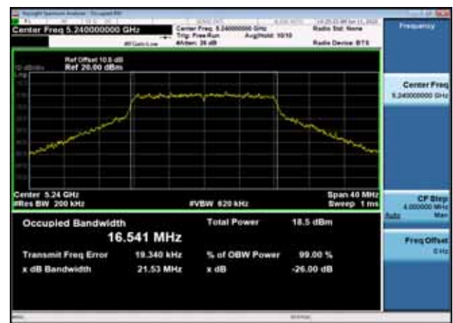
U-NII-1 26dB Bandwidth-802.11ac(20MHz) ,5180MHz,Ant1
