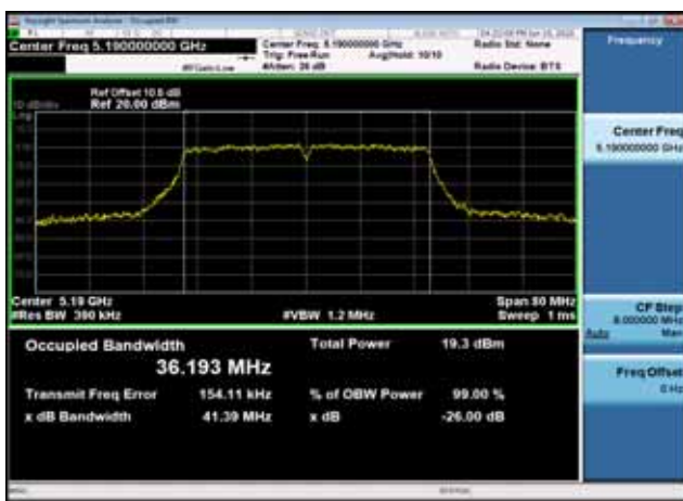
U-NII-1 26dB Bandwidth-802.11ac(40MHz),5190MHz,Ant0
