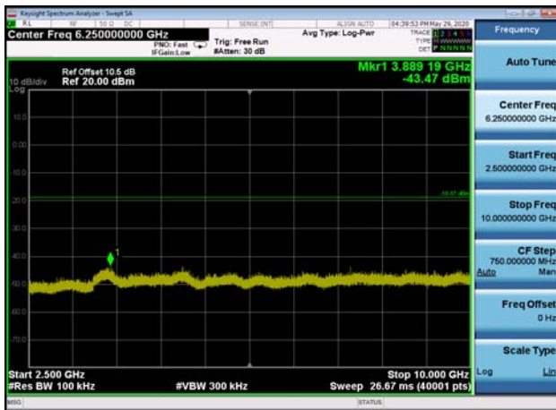
,Plot 4,2500MHz~10000MHz-802.11g ,2462MHz,Ant0
