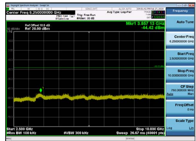
,Plot 4,2500MHz~10000MHz-802.11n(HT20) ,2462MHz,Ant0
