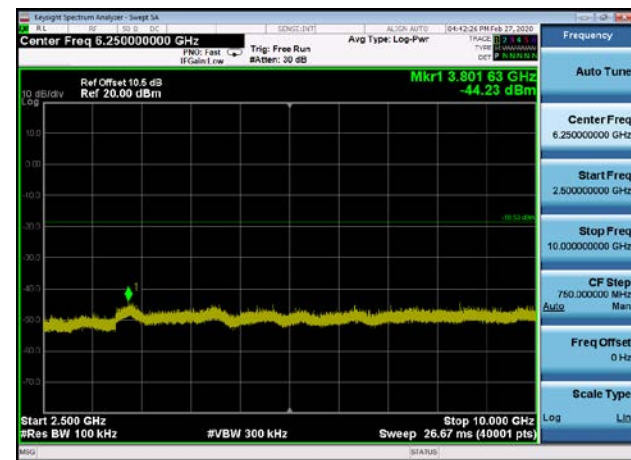
,Plot 4,2500MHz~10000MHz-802.11n(HT20) ,2437MHz,Ant0
