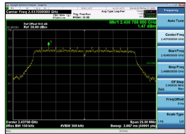
,Plot 2,Band Edge-802.11n(HT20) ,2412MHz,Ant0
