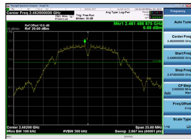
,Plot 2,Band Edge-802.11b,2437MHz
