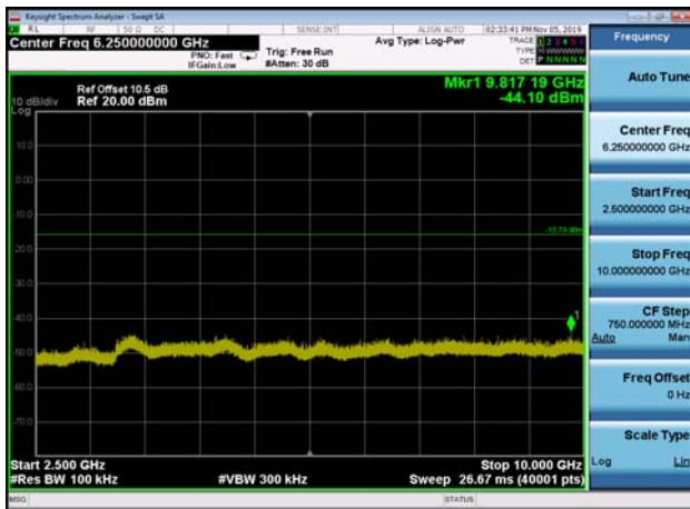
,Plot 4,2500MHz~10000MHz-802.11g ,2462MHz
