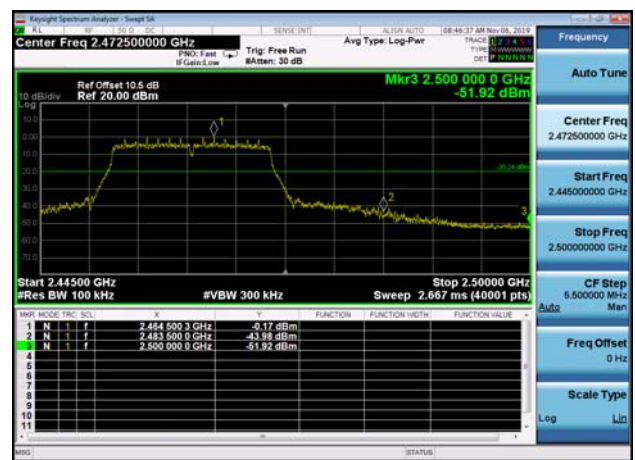
,Plot 2,Band Edge-802.11n(HT20) ,2462MHz
