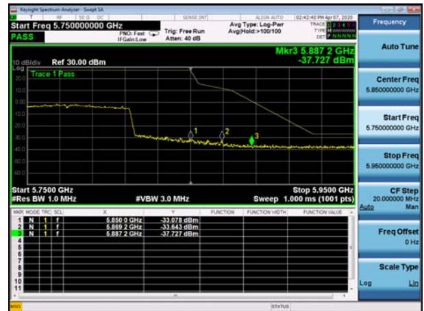
U-NII-3 ,Plot 2,30MHz~5000MHz-802.11n (20MHz),5785MHz
