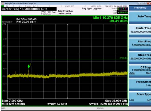
U-NII-1 ,Plot 4,7000MHz~26000MHz-802. 11ac(40MHz),5230MHz
