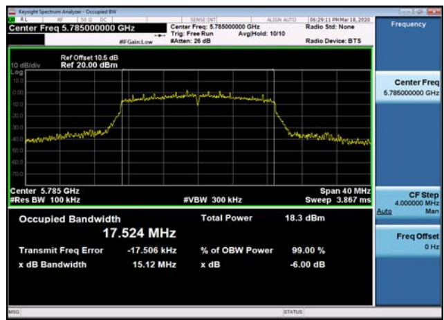
U-NII-3 6dB Bandwidth-802.11n(40MHz) ,5755MHz
