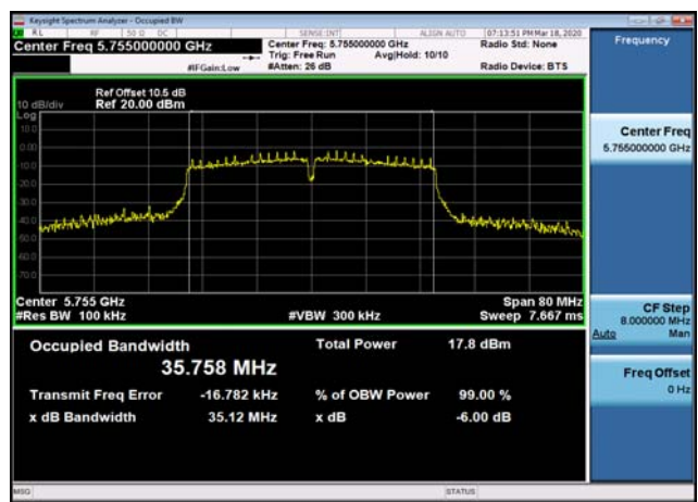
U-NII-3 6dB Bandwidth-802.11n(40MHz) ,5755MHz
