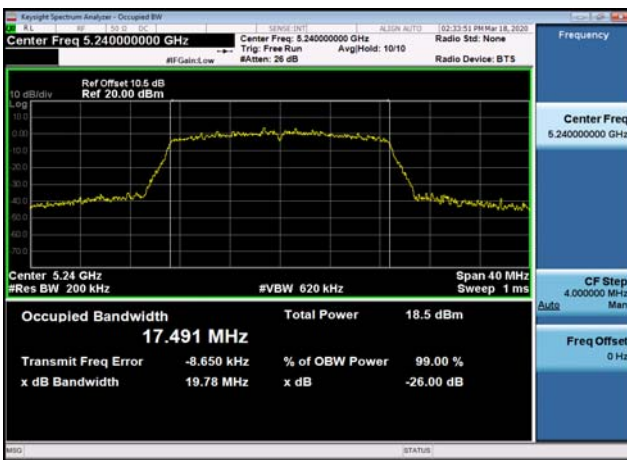
U-NII-1 26dB Bandwidth-802.11ac(20MHz) ,5240MHz
