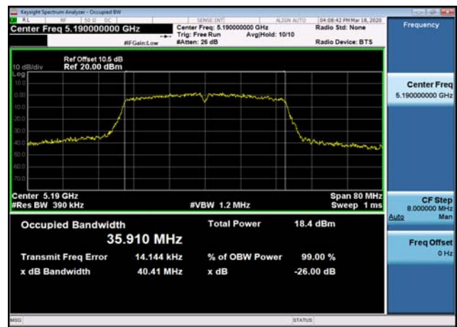
U-NII-1 26dB Bandwidth-802.11ac(40MHz) ,5190MHz
