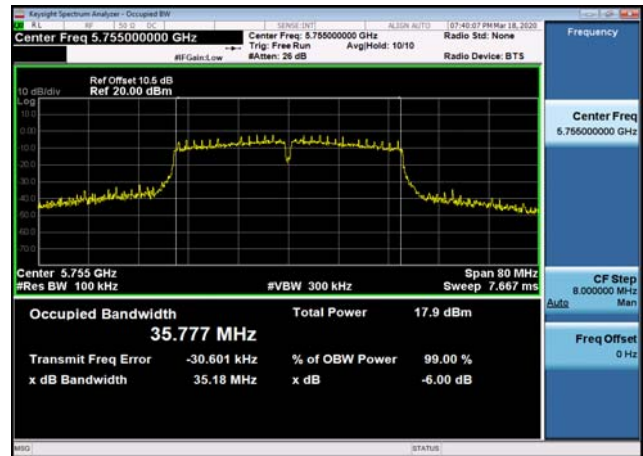
U-NII-3 6dB Bandwidth-802.11ac(80MHz) ,5775MHz
