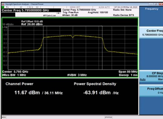
U-NII-3 Output Power-802.11ac(40MHz) ,5795MHz
