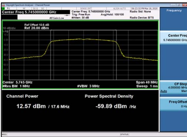
U-NII-3 Output Power-802.11n(20MHz) ,5825MHz
