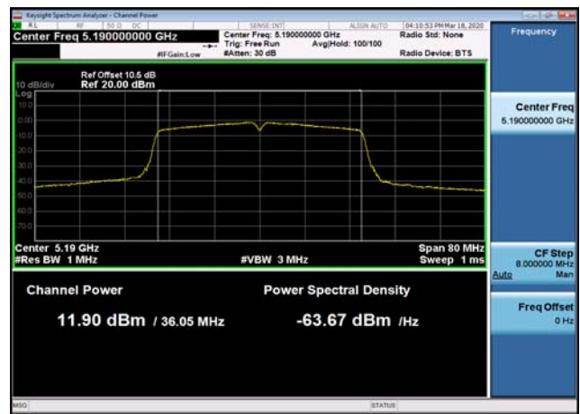
U-NII-1 Output Power-802.11ac(40MHz) ,5190MHz
