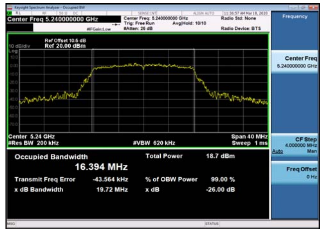
U-NII-1 26dB Bandwidth-802.11ac(20MHz) ,5220MHz
