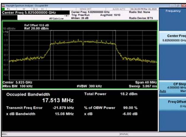
U-NII-3 6dB Bandwidth-802.11n(20MHz) ,5825MHz
