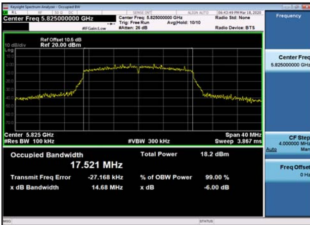
U-NII-3 6dB Bandwidth-802.11ac(40MHz) ,5795MHz
