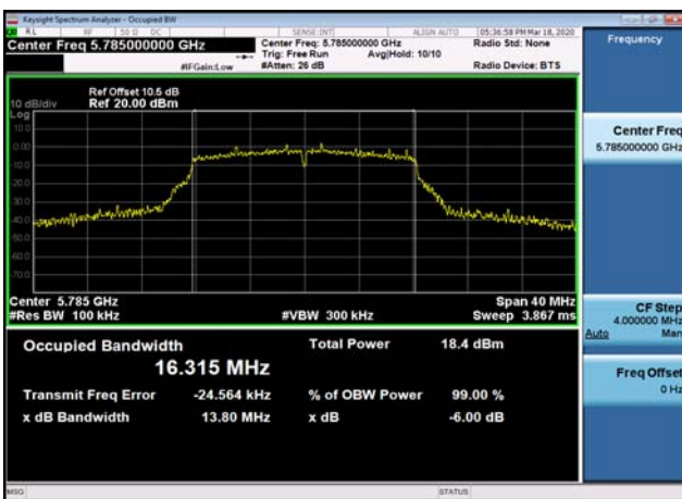
U-NII-3 6dB Bandwidth-802.11ac(20MHz) ,5745MHz
