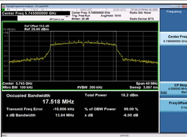
U-NII-3 6dB Bandwidth-802.11ac(20MHz) ,5745MHz
