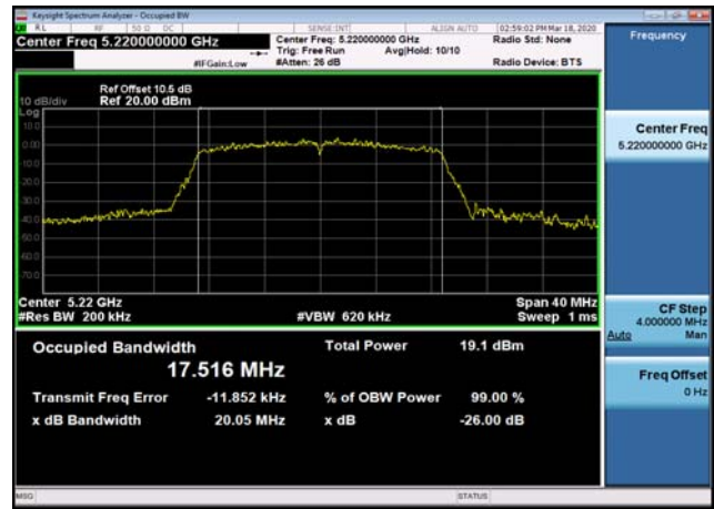
U-NII-1 26dB Bandwidth-802.11ac(40MHz) ,5190MHz
