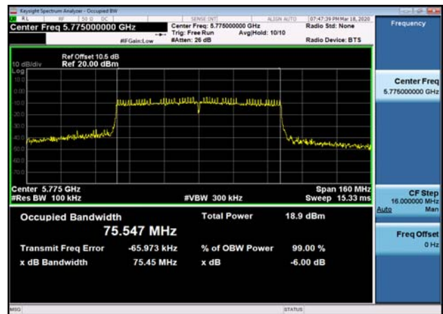
U-NII-3 6dB Bandwidth-802.11ac(80MHz) ,5775MHz
