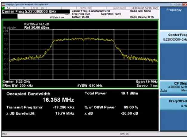
U-NII-1 26dB Bandwidth-802.11ac(20MHz) ,5180MHz
