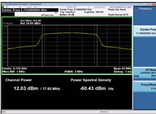
U-NII-3 Output Power-802.11n(20MHz) ,5825MHz
