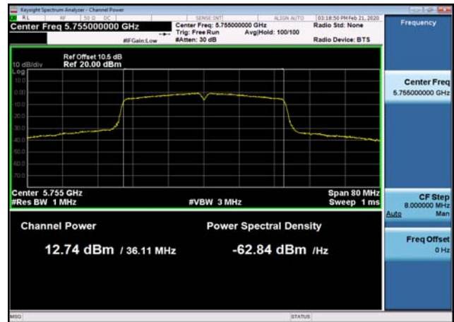
U-NII-3 Output Power-802.11ac(80MHz) ,5775MHz
