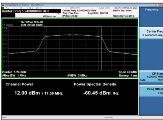
U-NII-1 Output Power-802.11ac(20MHz) ,5240MHz
