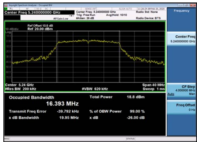
U-NII-1 26dB Bandwidth-802.11ac(20MHz) ,5220MHz
