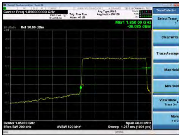
NR n25 256QAM 20MHz CH-Low 100%RB
