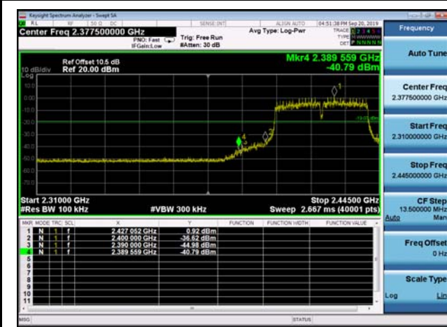
,Plot 2,Band Edge-802.11n(HT40) ,2437MHz,Ant0
