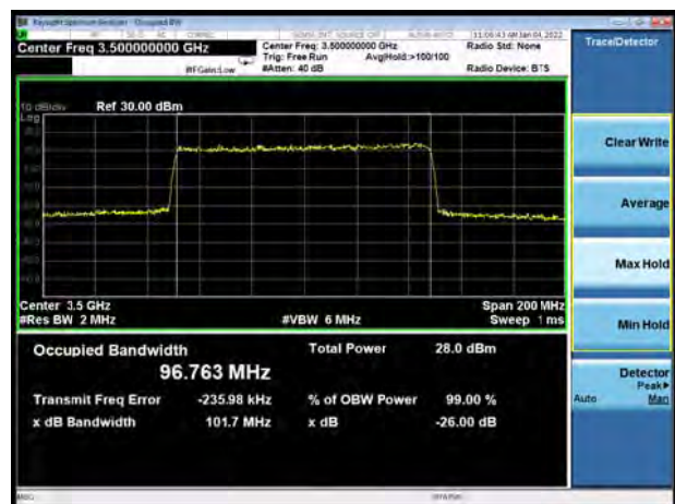
DC_7A-n78 16QAM 100%RB 100MHz CH- Middle
