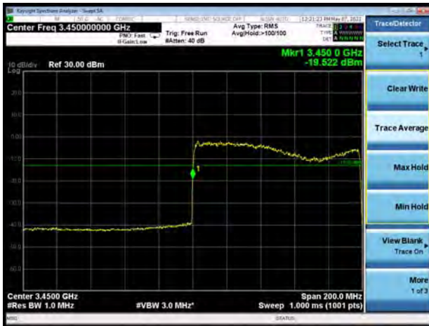
NR n77 subset 1 QPSK 100MHz CH-Low 1RB
