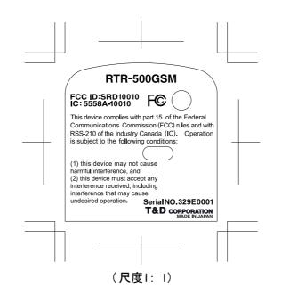
丸孔の2ヶ所は抜き シリアルNo. の詳細は別途図面参照 0001からのFFFFまでの16進数
