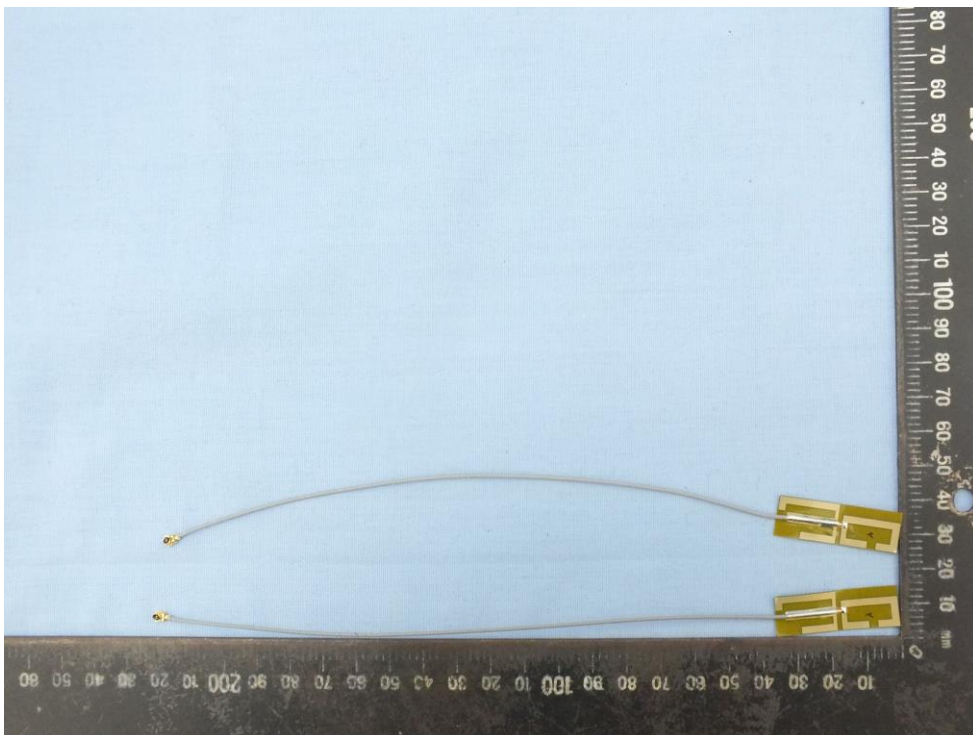
Antenna: Laird MAF95310 Mini NanoBlade Flex
