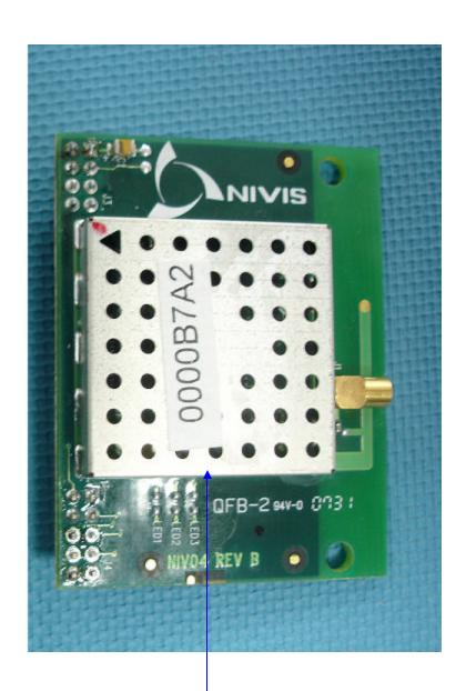
2.4 GHZ MOD2 LABEL WILL BE LOCATED ON TOP OF THE RF SHIELD
