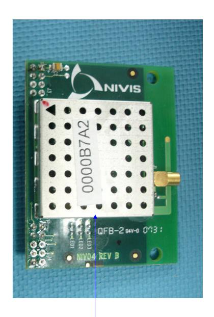
2.4 GHZ AINODE LABEL WILL BE LOCATED ON TOP OF THE RF SHIELD
