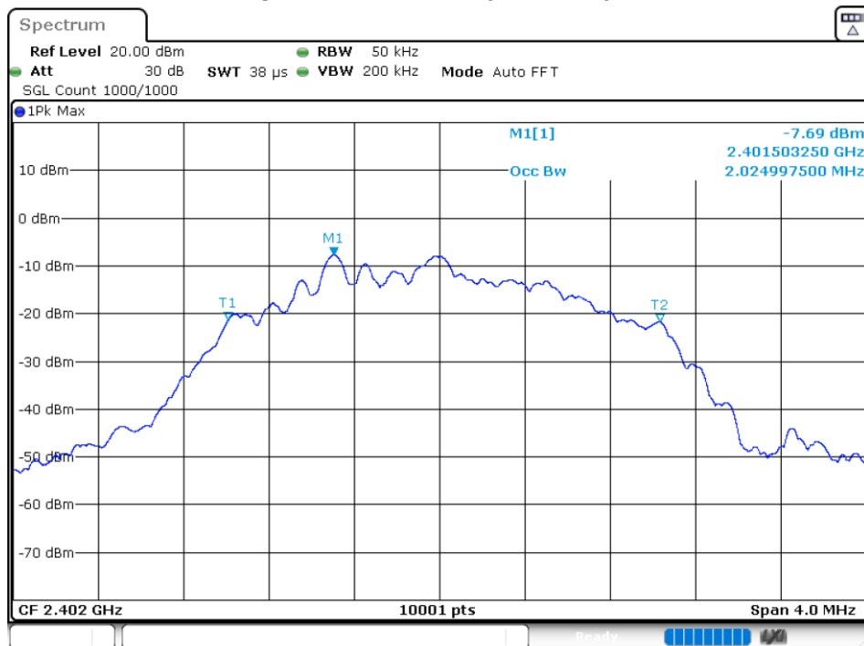
OBW NVNT BLE 2402MHz Ant1
