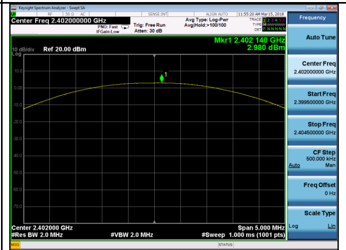
\pi/4 DQPSK Output power - Low CH 2402
